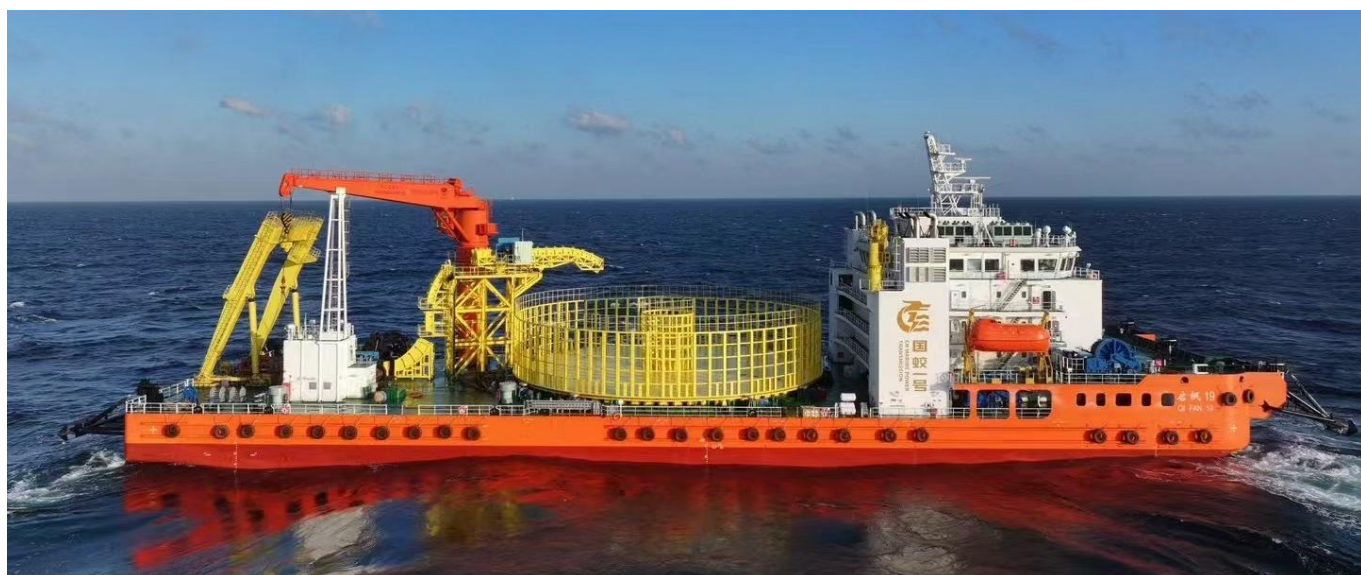
10000吨级新型海缆施工船
