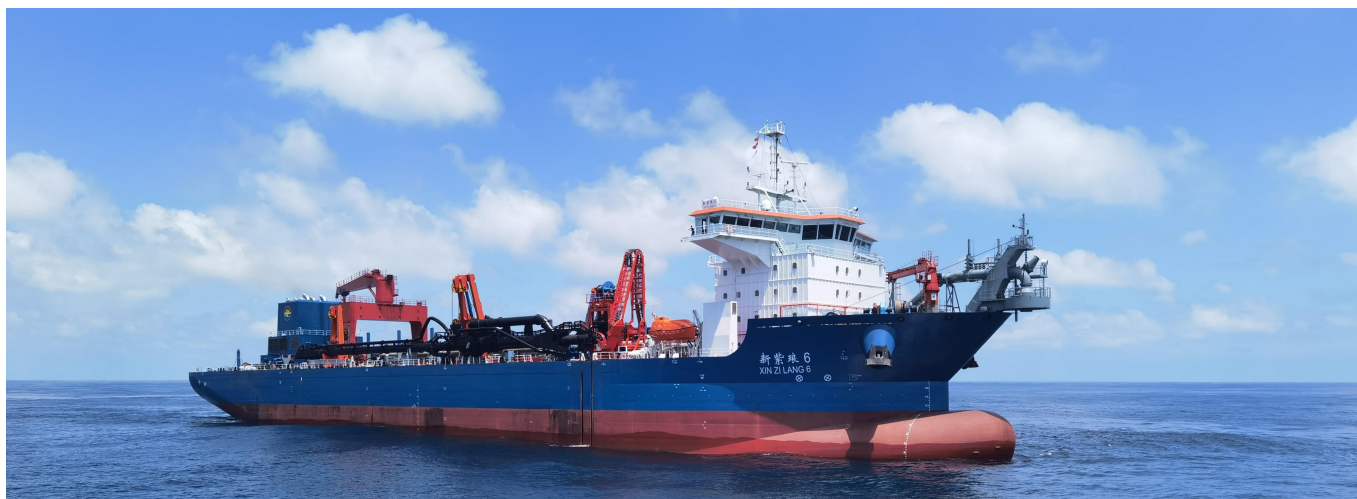
26800m 3 耙吸式大型挖泥船
