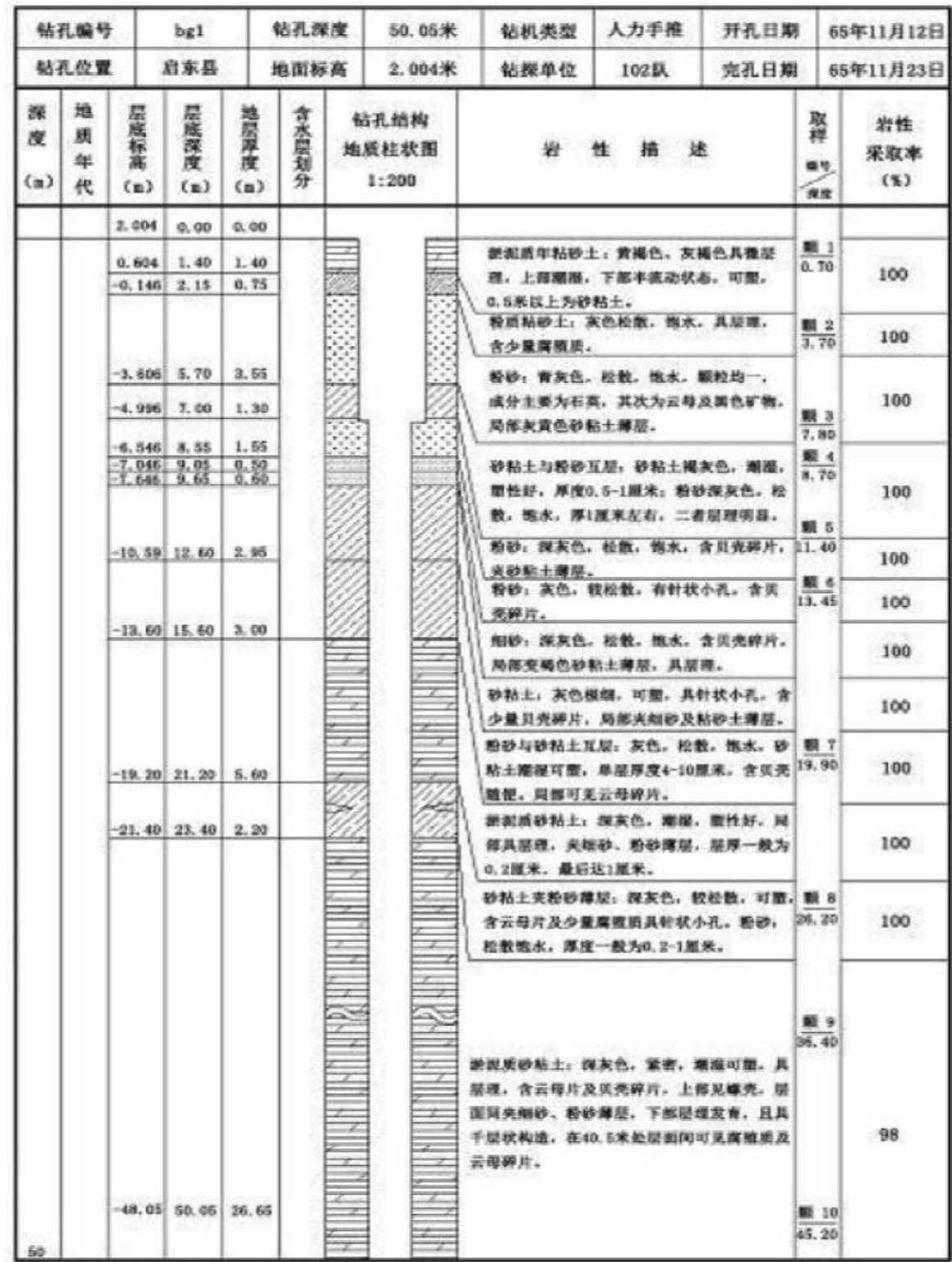
图 5.4-1 海门地区典型钻孔柱状图
